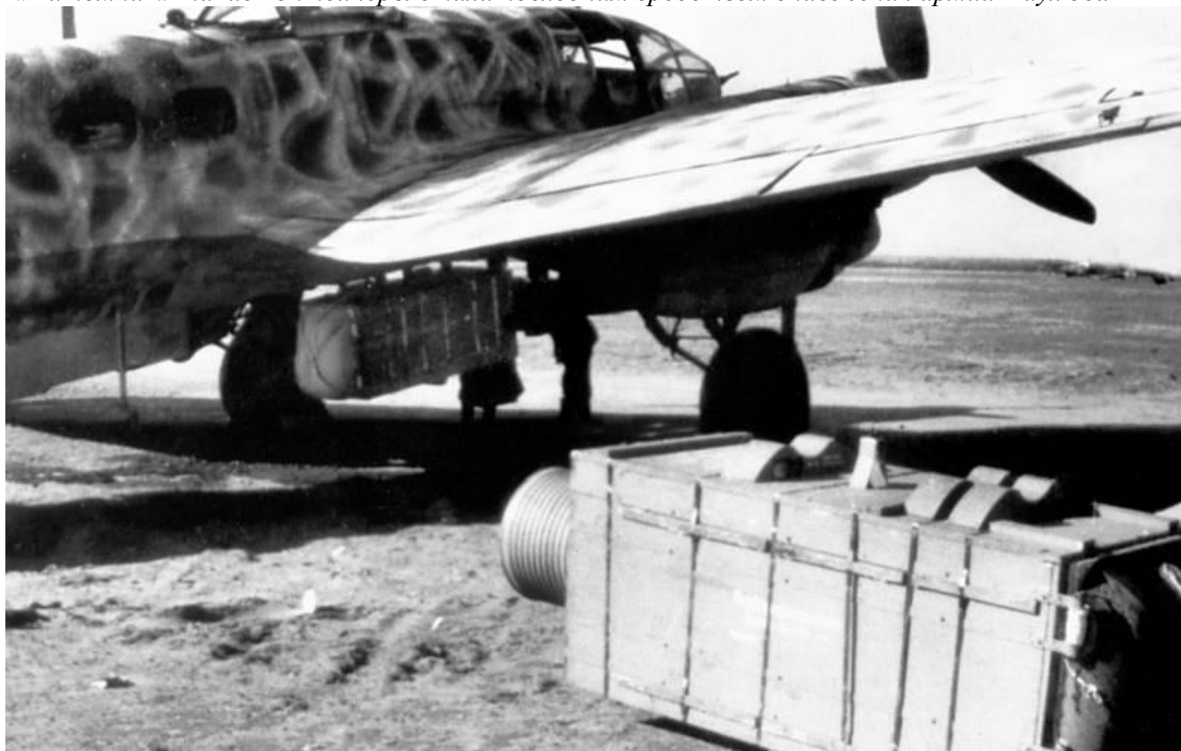
Подвеска парашютного контейнера снабжения на бомбардировщик Хейнкель-111. Хорошо виден гофрированный амортизатор, сохраняющий груз от повреждения при ударе о землю
