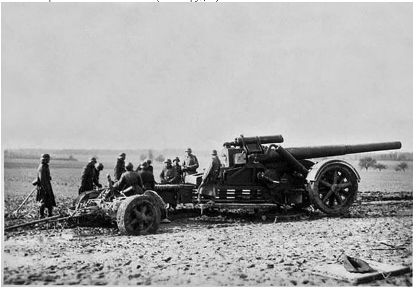
210-мм немецкая гаубица Moerser 18. Армия Ф. Паулюса была значительно усилена орудиями этого типа перед началом битвы за Сталинград. Орудие было способно забрасывать 113-кг снаряды на 16 700 метров
