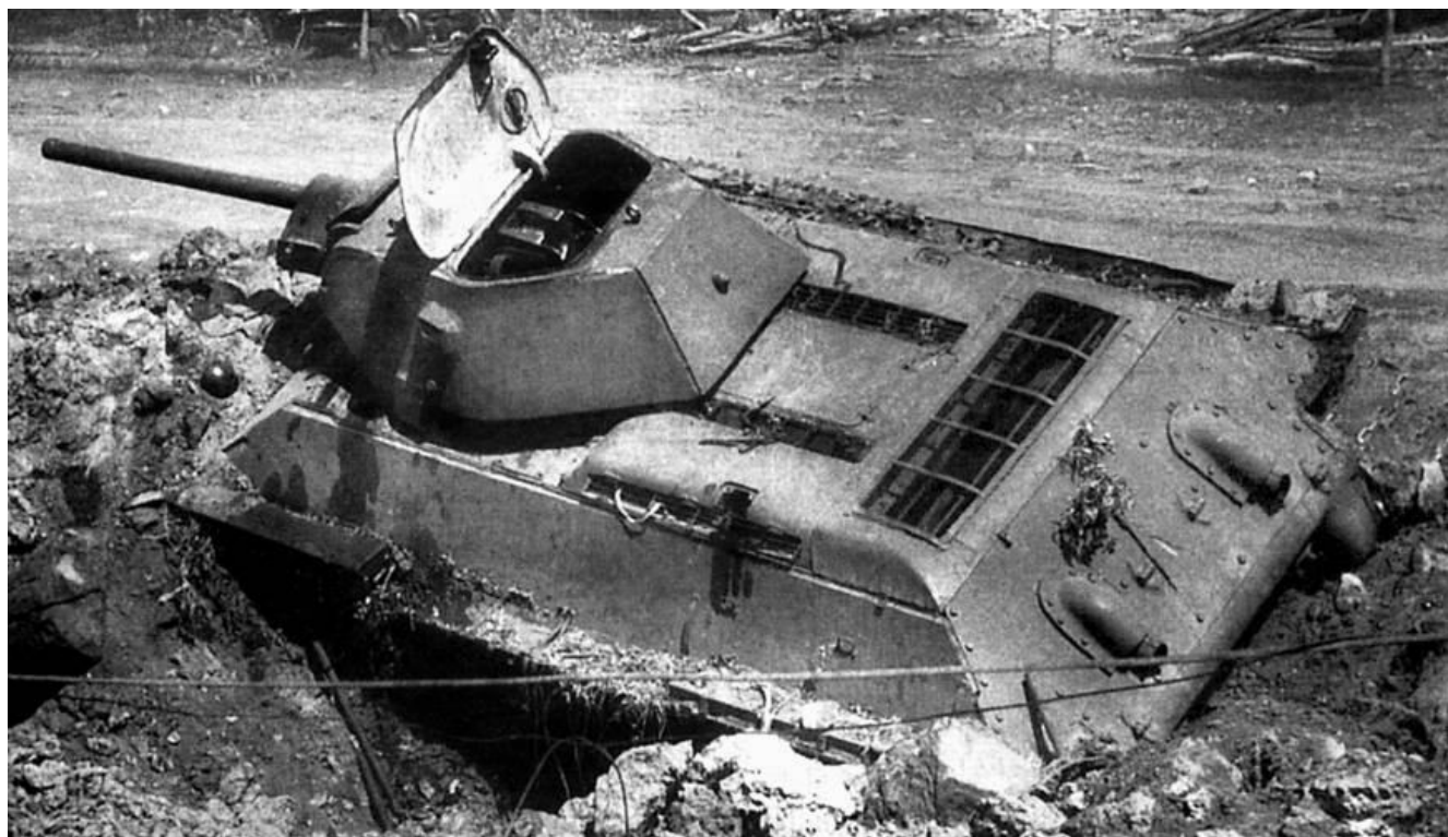
Танк Т-34 производства СТЗ, брошенный в пригороде Сталинграда. Машина содержит все характерные черты поздних «сталинградоков» – приварной кормовой лист башни-«пирожка», квадратный люк доступа к трансмиссии и др.
